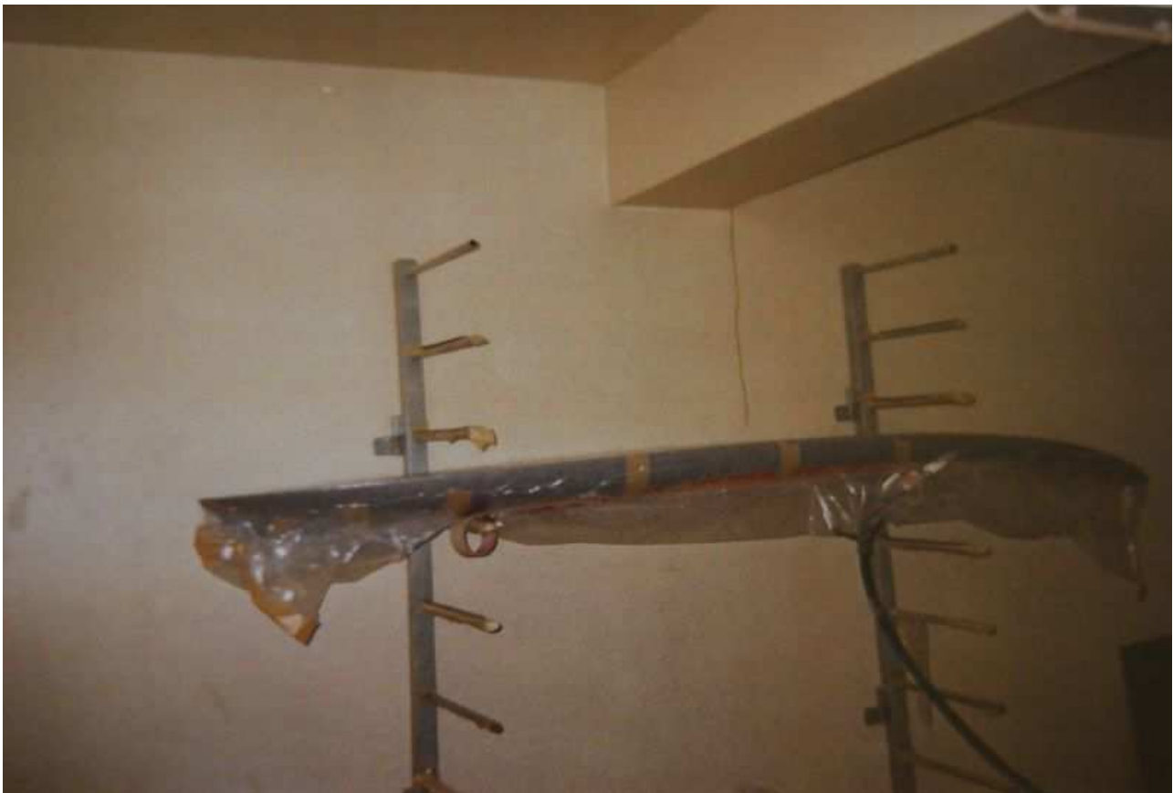
Stratification sous vide en cours de réticulation en étuve.
