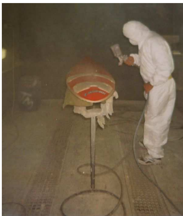
Finition : Pose de l'antidérapant. On remarque le masquage soigné de la carène et des pads.
